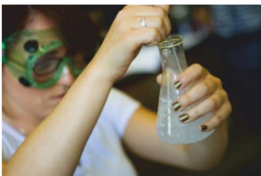
სურათი 3.7. მექანიკური მორევა ძლიერ აჩქარებს გახსნის ან შერევის პროცესს
