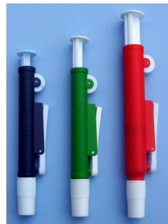
სურათი 2.18. პიპეტებში ნივთიერების ამოსატუმბი მონწყობილობა
