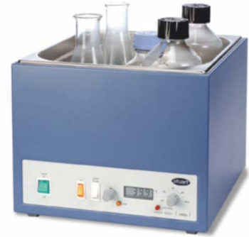
სურათი 3.21. წყლის აბაზანა ავტომატური გამაცხელებლით
