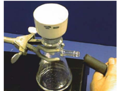
10. ძაბრიდან წვეთების ჩამოვარდნის შეწყვეტის შემდეგ მოვხსნათ ვაკუუმთან შემაერთებელი მილი და შემდეგ გადავკეტოთ წყლის ონკანი
