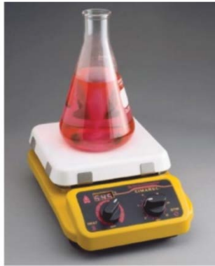
სურათი 3.8. მაგნიტური სარეველა. მორევა წარმოებს მინით ან პოლიმერით დაფარული მაგნიტის ღეროთი
