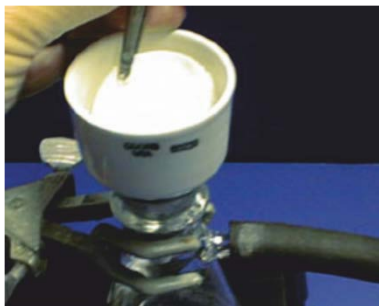
11. პინცეტის ან შპატელის საშუალებით ძაბრიდან ამოვიღოთ ნალექი ფილტრის ქაღალდიანად
