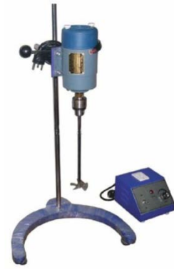
სურათი 3.9. მექანიკური სარეველა. მორევა წარმოებს ელექტროძრავასთან მიერთებული მინის ან უჟანგავი ფოლადის სარეველით
