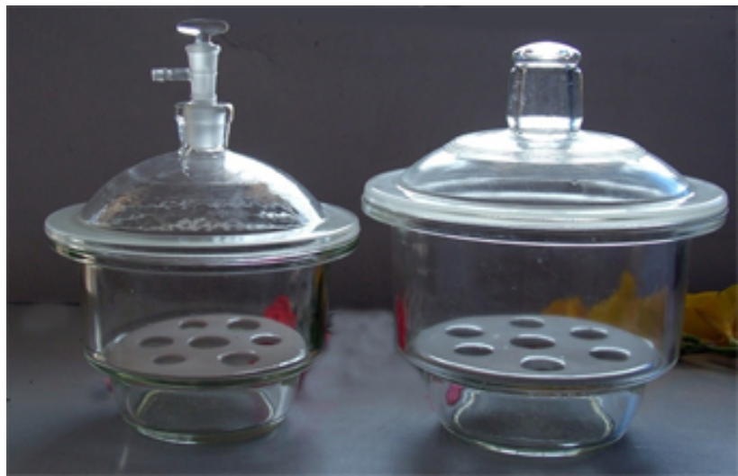
სურათი 2.13. ექსიკატორები: ვაკუუმ-ექსიკატორი (მარცხნივ) და ჩვეულებრივი ექსიკატორი (მარჯვნივ)
